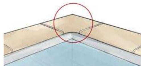
Rapides et faciles à mettre en place. Des formats standards sont disponibles, cependant nous pouvons également réaliser des pièces d'angle de piscine en pierre naturelle sur mesure. Cette technique permet de suivre l'éventuel angle arrondi de la piscine.
