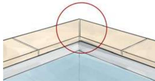
Cette technique nécessite une coupe parfaite. Le principal avantage de cette technique est qu'elle permet de former des angles de piscine avec des margelles en bord 1/2 rond ou en bord droit sans avoir besoin de margelles d'angle.
